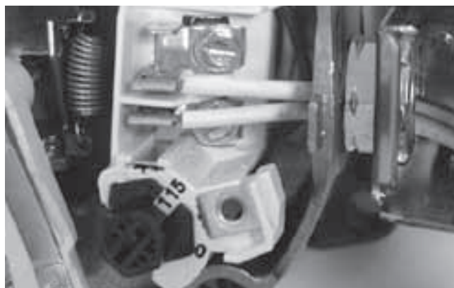
Figure 11 : Tension réglée à 115 volts sur sélecteur à cadran
