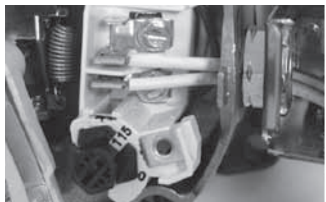
Figura 11: Tensión configurada para 115 voltios, tipo cuadrante.
